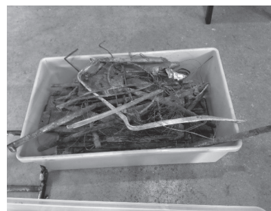
焼却炉の中から出てきた燃え残った金属くず (施設の運転停止につながります。) ※施設の運転ができなくなると、ごみ収集を 停止せざるを得なくなります。
