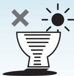
太陽光（紫外線） 劣化が進み、退色
