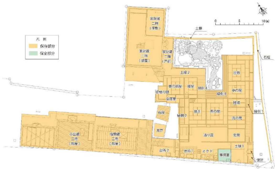
図-9 主屋一階、家財蔵二階、塩物蔵二階、小豆蔵二階、外部 平面図（部分の設定）
